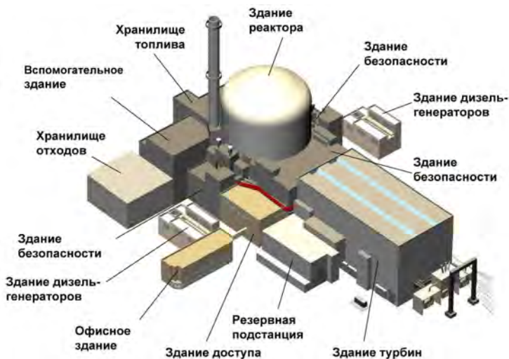
Рис. 2.1. План электростанции Areva Nuclear Power [8]
